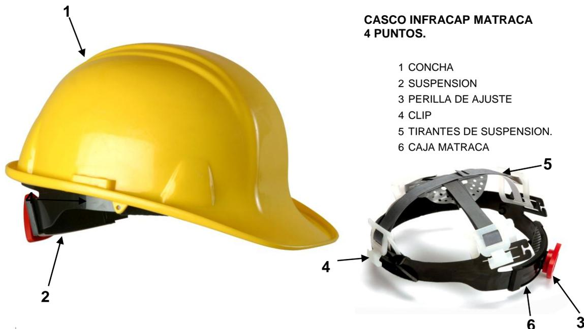
Fabricado en polietileno de alta densidad resistente a altos impactos, ofrece resistencia al impacto, penetración y dieléctrica de 20,000 V hasta 30,000 V.
